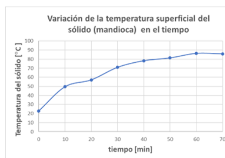
Figura 1 a 4 Datos de secado para mandioca en ensayos de laboratorio cátedra Operaciones Unitarias, Departamento de Ingeniería Química, Facultad de Ingeniería UNSJ, 2024
